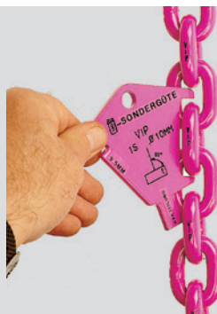
Ylikuorman aiheuttaman venymän tarkastus
