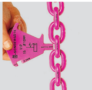
Kuluman aiheuttaman pitenemän tarkastus
